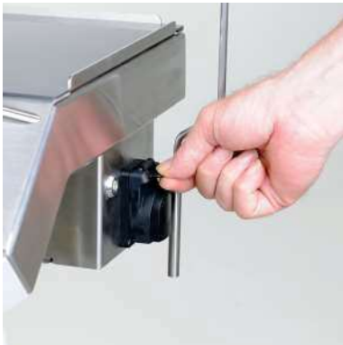
Pumpendeckel öffnen. Griff nach oben ziehen.
